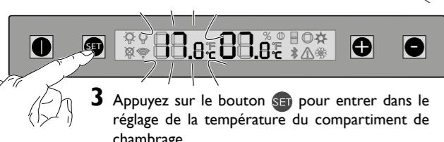
3 Appuyez sur le bouton **SET** pour entrer dans le réglage de la température du compartiment de chambrage..
